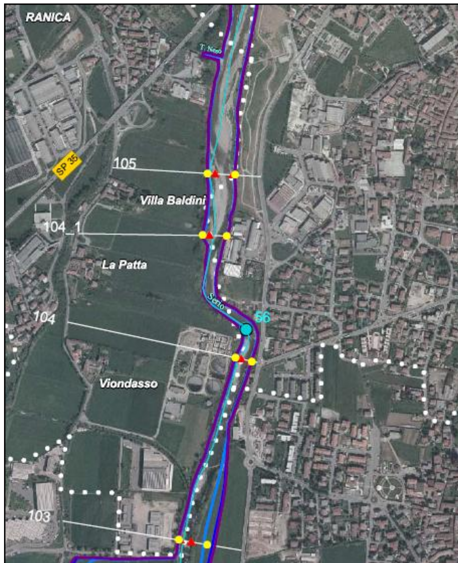
Figura 67 - Stralcio planimetrico AdBPo con indicazione delle aree di allagamento per diversi Tempi di ritorno.
